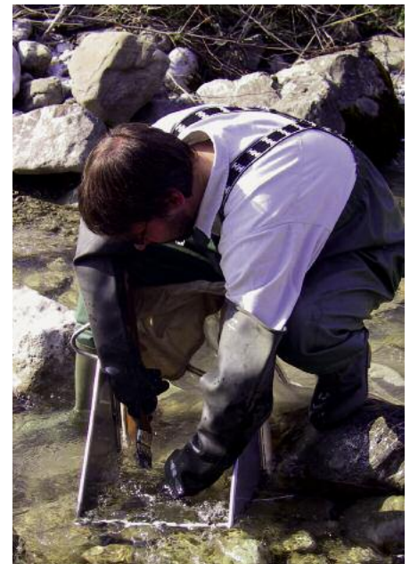
Oben: Mit dem Surber-Sampler wird eine definierte Bachsohlenfläche aufgewirbelt. Die darin lebenden Wasserkleintiere werden eingefangen und bestimmt.
